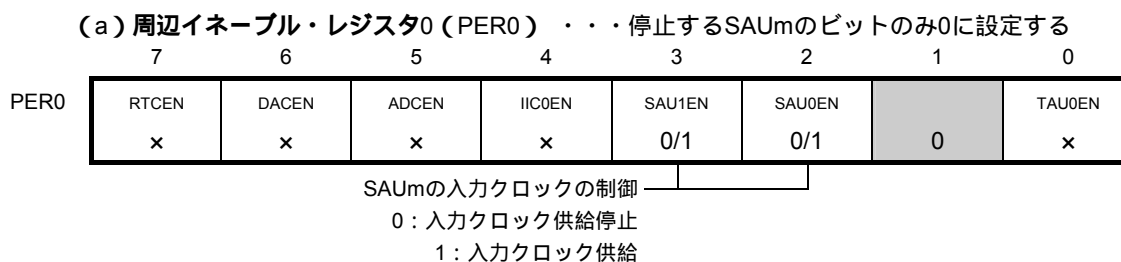
図12-22 ユニット単位で動作停止とする場合の周辺イネーブル・レジスタ0 (PER0) の設定
