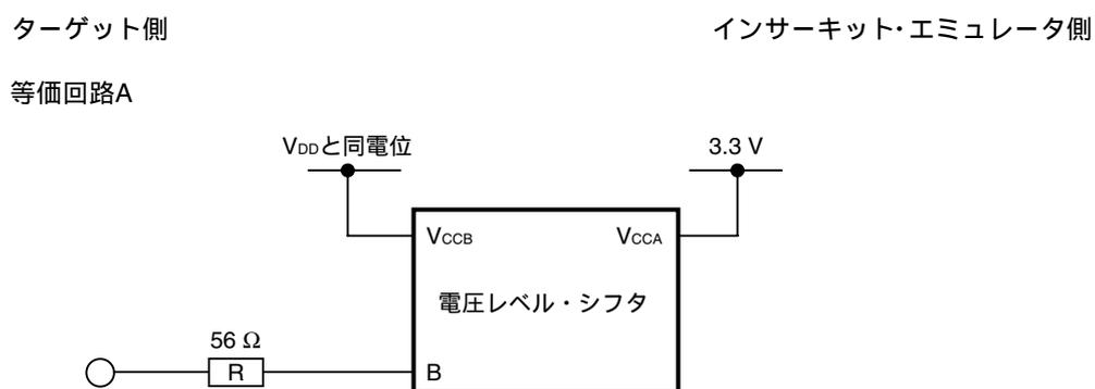
図A - 1 ターゲット・インタフェースの等価回路 (2/9)
