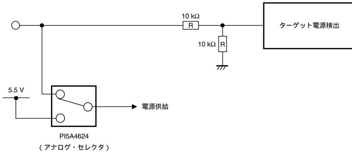
図A - 1 ターゲット・インタフェースの等価回路 (9/9)
