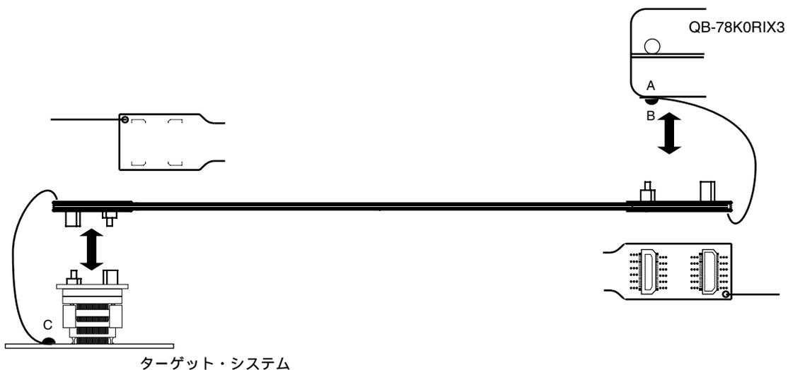
ターゲット・コネクタに、エキステンジ・アダプタ、エミュレーション・プローブを接続します。
