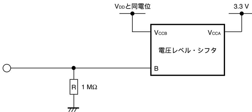
図A - 1 ターゲット・インタフェースの等価回路 (6/9)
