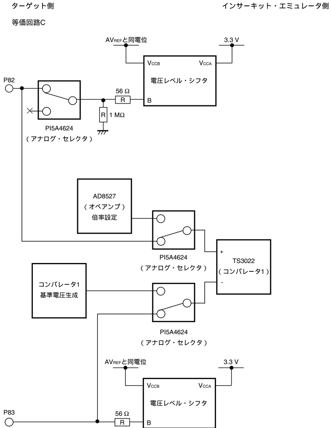
図A - 1 ターゲット・インタフェースの等価回路 (4/9)
