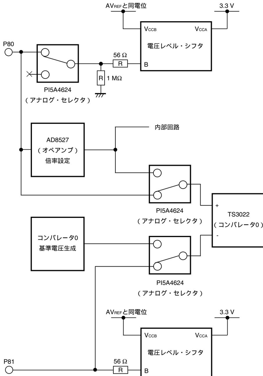
図A - 1 ターゲット・インタフェースの等価回路 (3/9)
