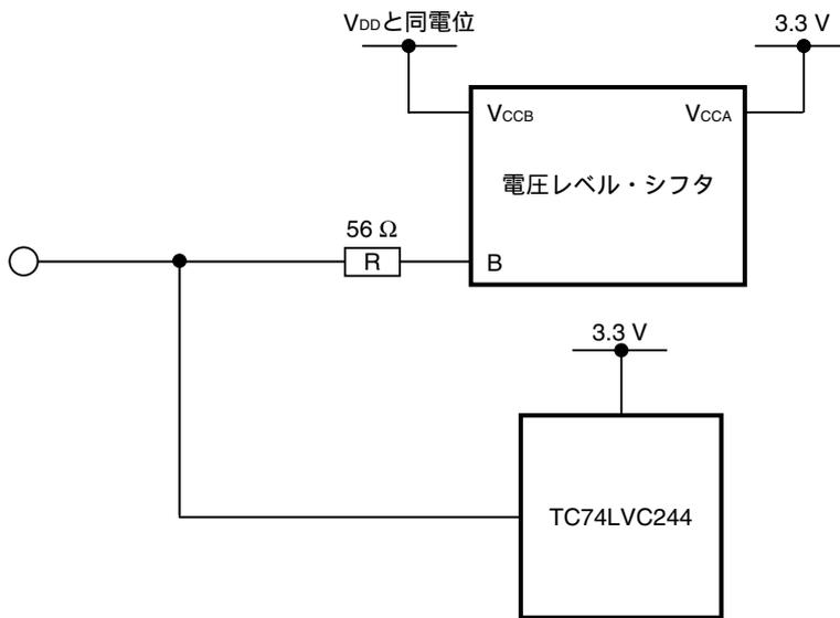
図A - 1 ターゲット・インタフェースの等価回路 (5/9)
