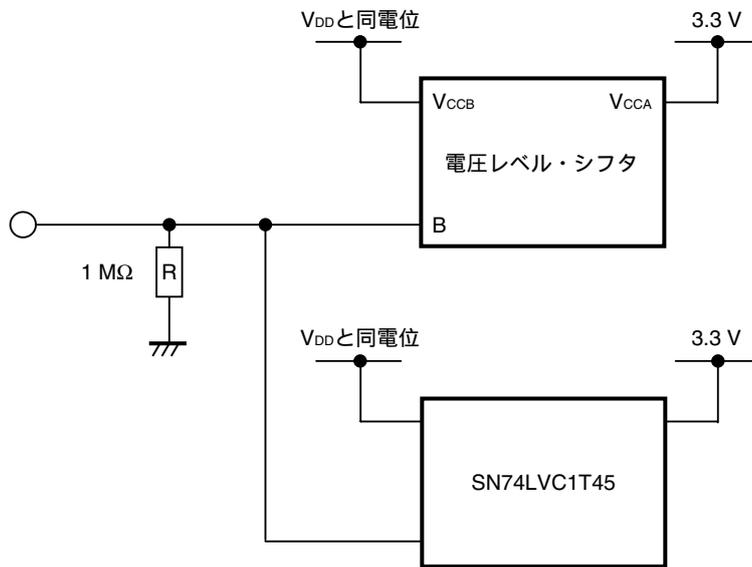
図A - 1 ターゲット・インタフェースの等価回路 (7/9)
