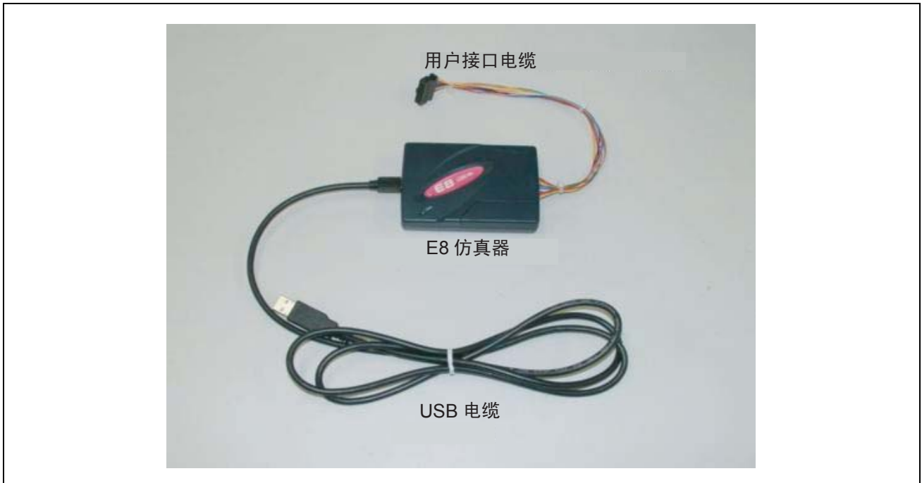
图 3.2 E8 仿真器的硬件构成
