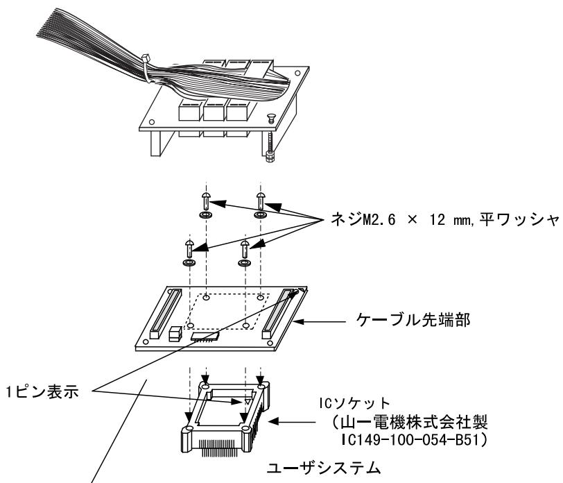
図 3 IC ソケットへの装着
