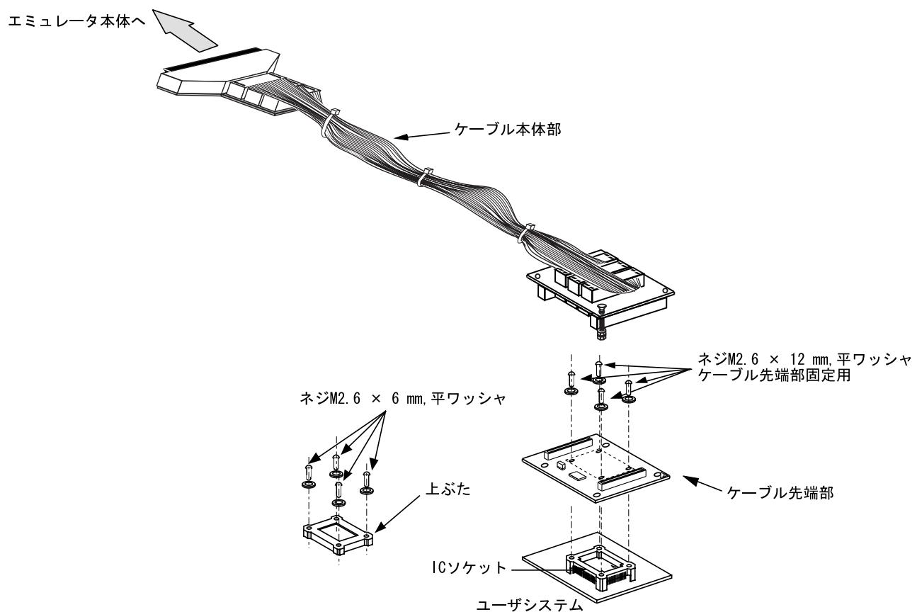
図 1 HS2268ECH61H ユーザシステムインターフェースケーブル
