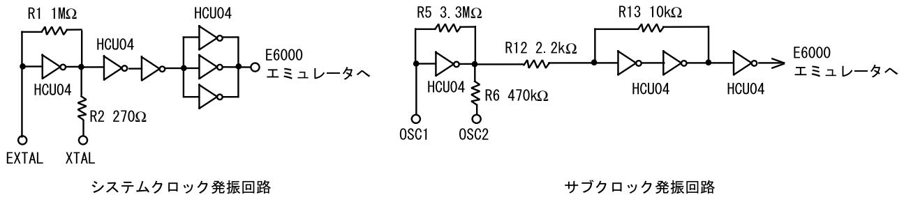
図 9 クロック発振回路
