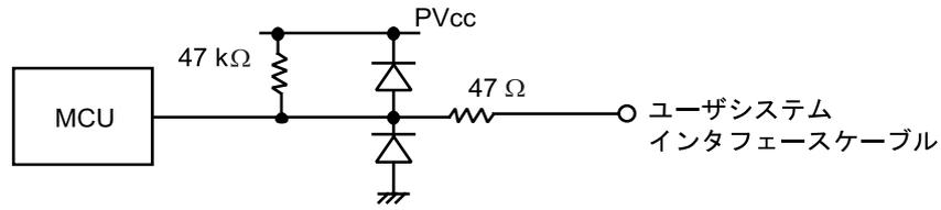
図 2-1 ユーザインタフェース信号回路
