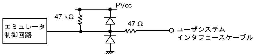
図 2-2 モード端子信号回路
