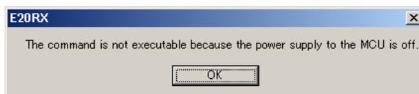
图 5.61 [Command Processing]（命令处理错误）对话框
