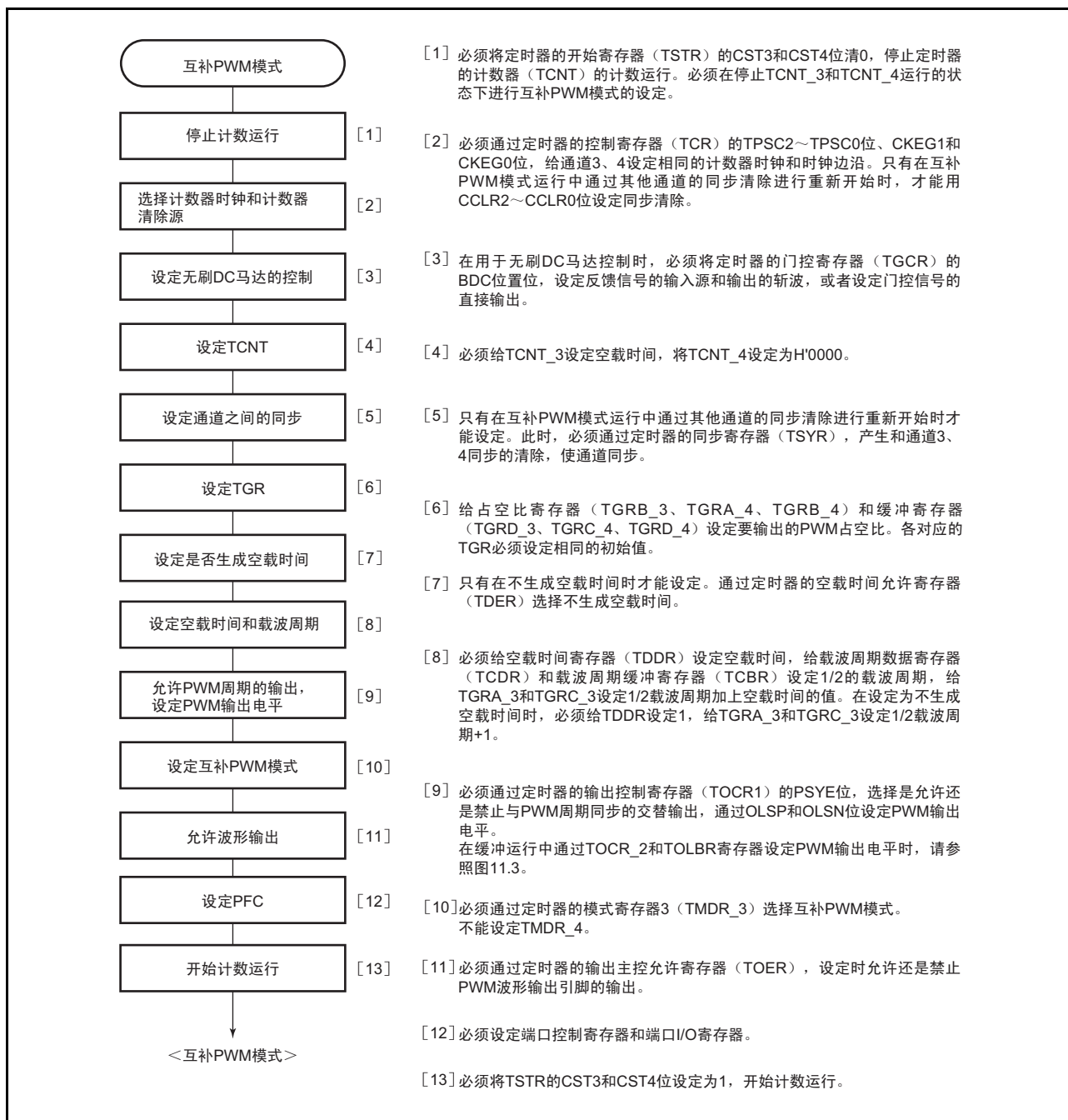
图 11.38 互补 PWM 模式的设定步骤例子
