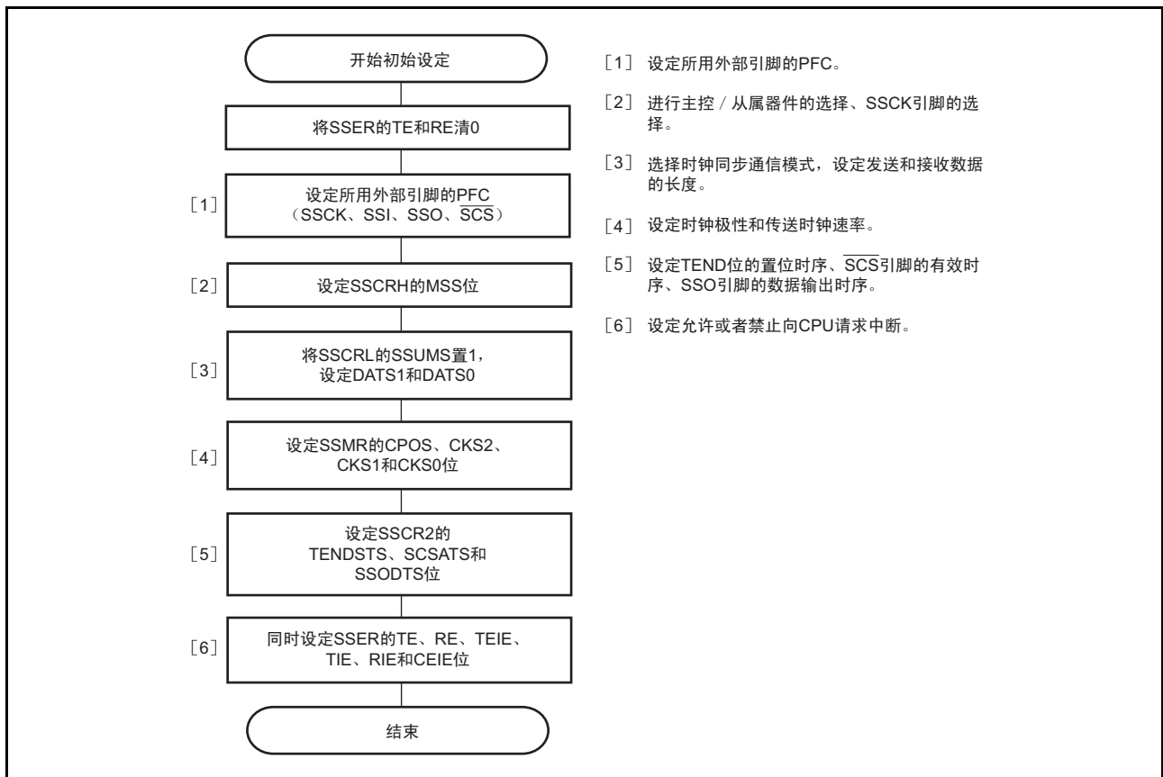
图 17.12 时钟同步通信模式的初始设定例
