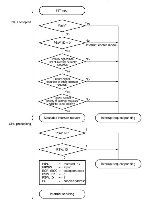
Figure 5-6. Maskable Interrupt Servicing
