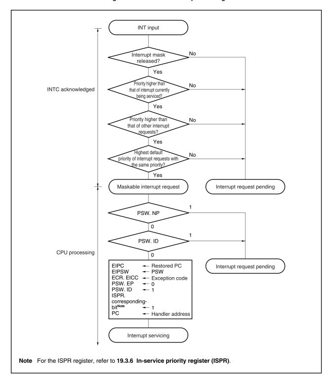
Figure 19-4. Maskable Interrupt Servicing
