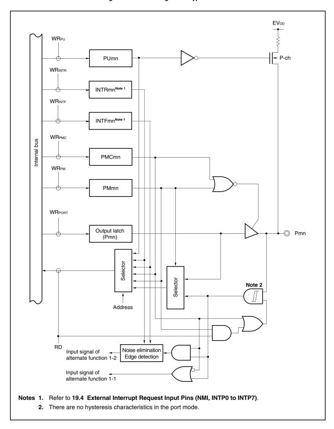
Figure 4-7. Block Diagram of Type D1-SUIHL
