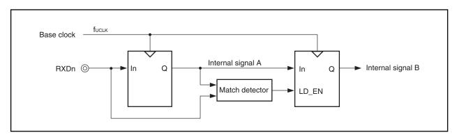
Figure 15-10. Noise Filter Circuit
