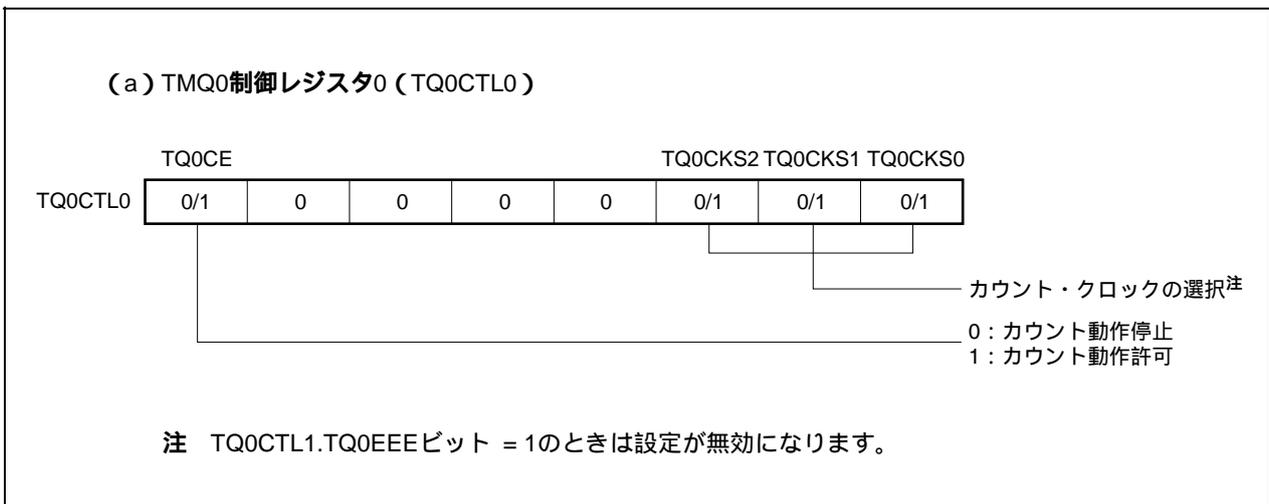
図9 - 22 外部トリガ・パルス出力モード動作時のレジスタ設定内容 (2/3)
