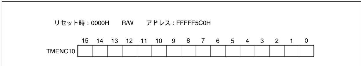
TMENC10のスタートおよびストップは, TMC10.CE101ビットによって制御します。
