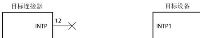
图15-4. QB-MINI2 用于调试且INTP1 引脚的调试仅通过实机进行情况下的电路连接
