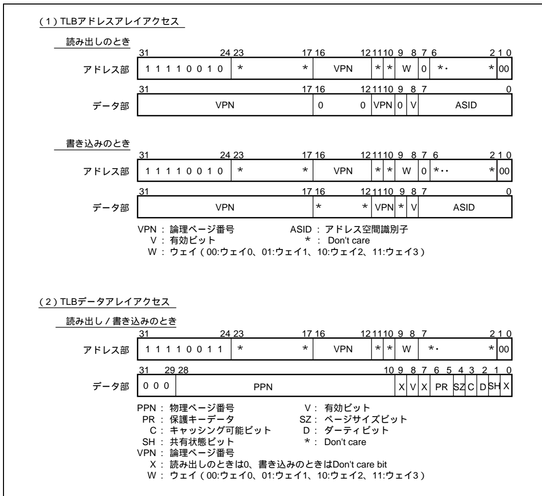
図 4.14 メモリ割り付けされた TLB アクセスのアドレス部、データ部指定方法
