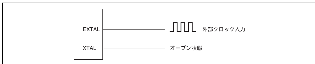
図 4.4 外部クロックの接続例
