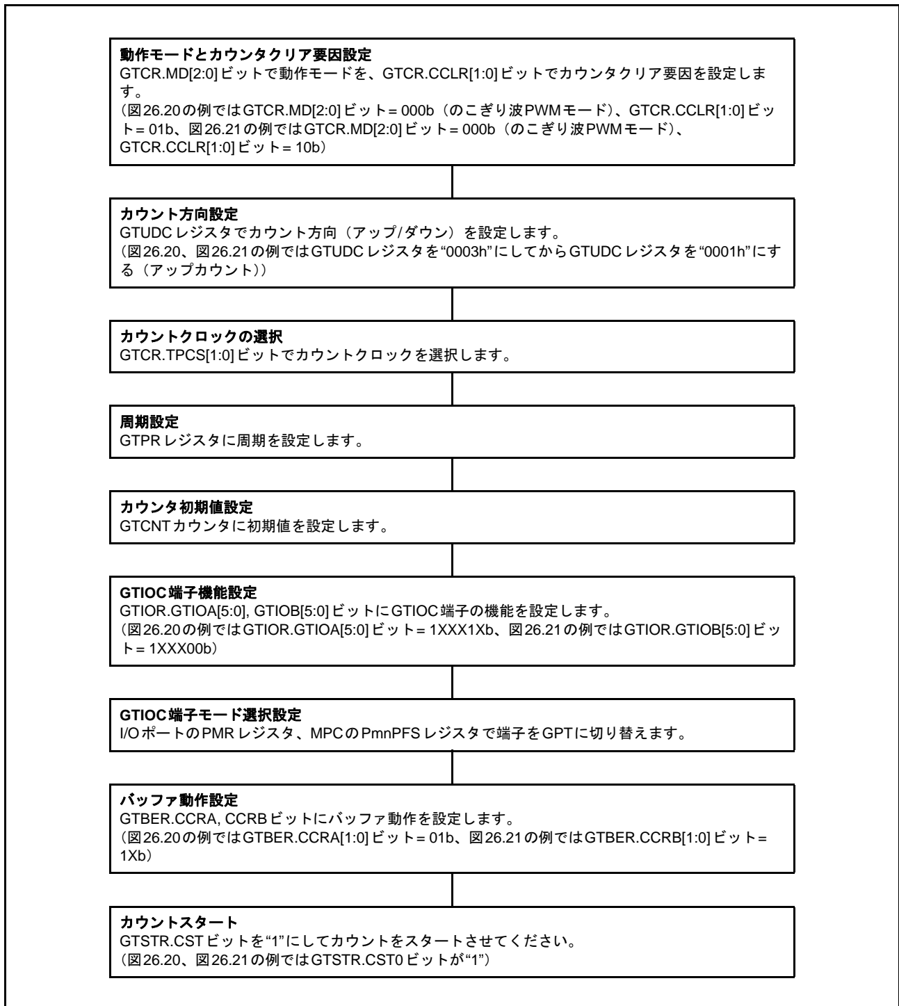
図 26.22 GTCCRA, GTCCRB レジスタのバッファ動作設定例 (インプットキャプチャ時)
