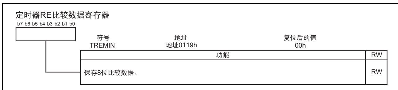
图 15.73 输出比较模式时的 TREMIN 寄存器
