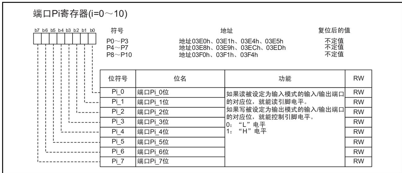
通过读写 Pi 寄存器，和外部进行数据的输入和输出。Pi 寄存器由保持输出数据的端口锁存器和读引脚状态的电路构成。
