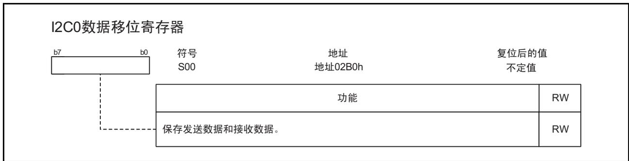
必须在发送时写发送数据。如果在接收时读 S00 寄存器，就能读到接收数据。在主控模式中，此寄存器也用于产生开始条件或者停止条件（参照“25.3.2 开始条件的产生方法”和“25.3.3 停止条件的产生方法”）。
