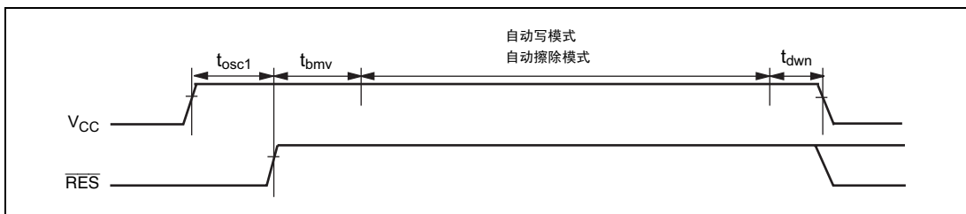
图 6.20 振荡稳定时间、编程器模式准备时间和 Vcc 保持时间的顺序
