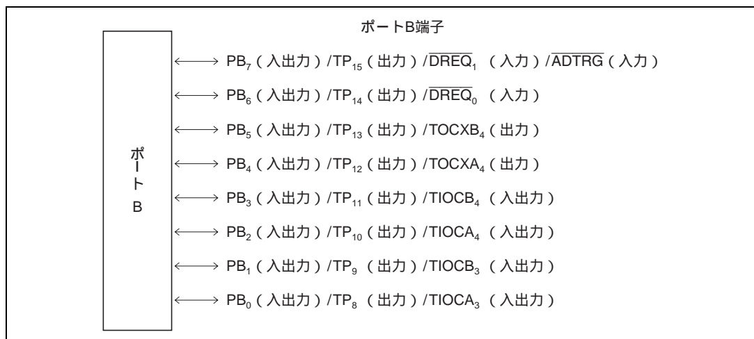
図 9.29 ポート B の端子構成
