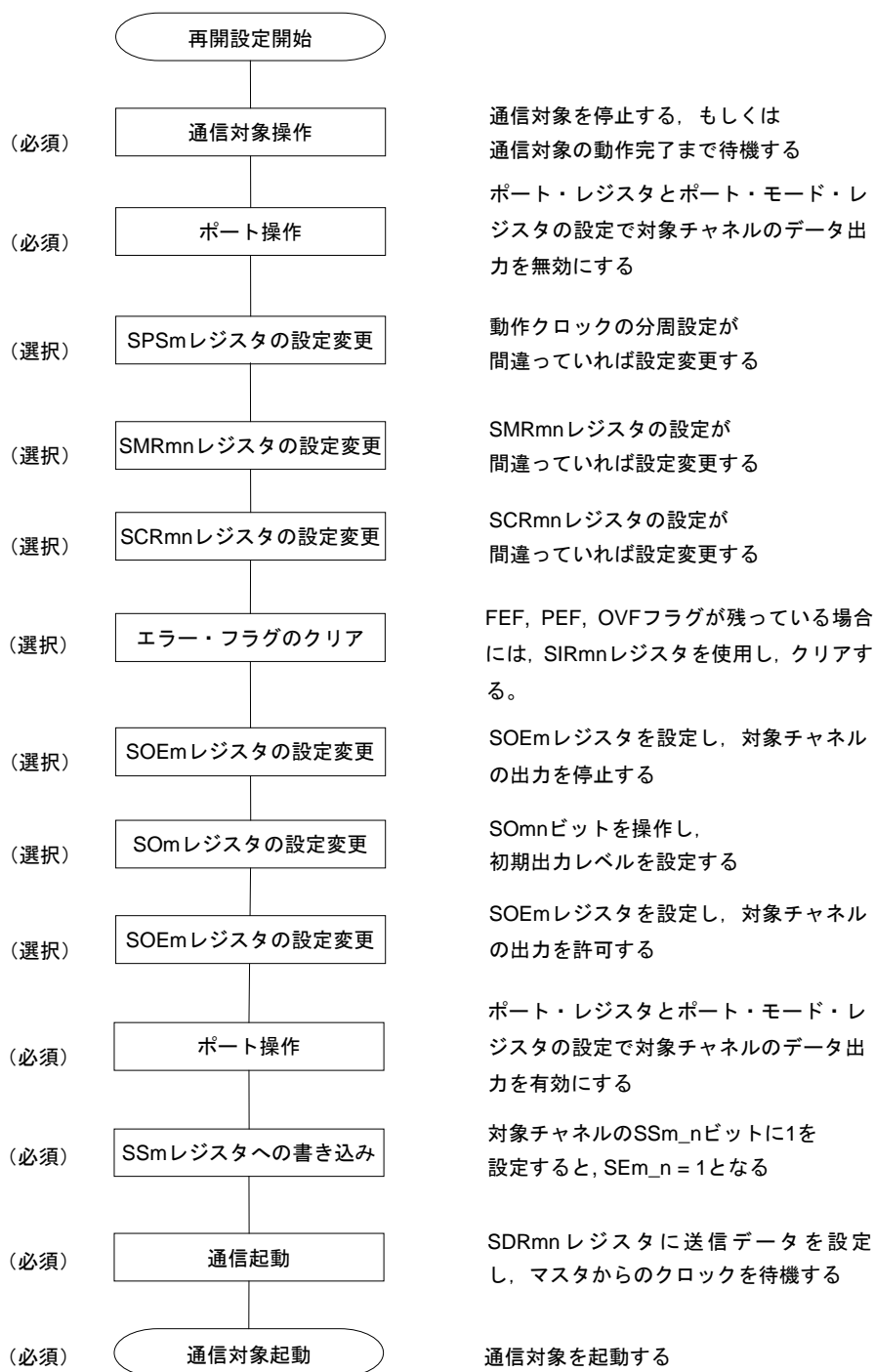
図11-68 スレーブ送受信の再開設定手順
