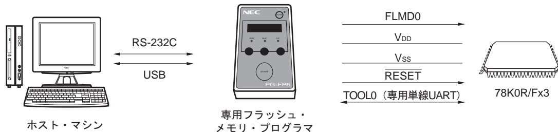
図24-4 コード・フラッシュ・メモリにプログラムを書き込むための環境
