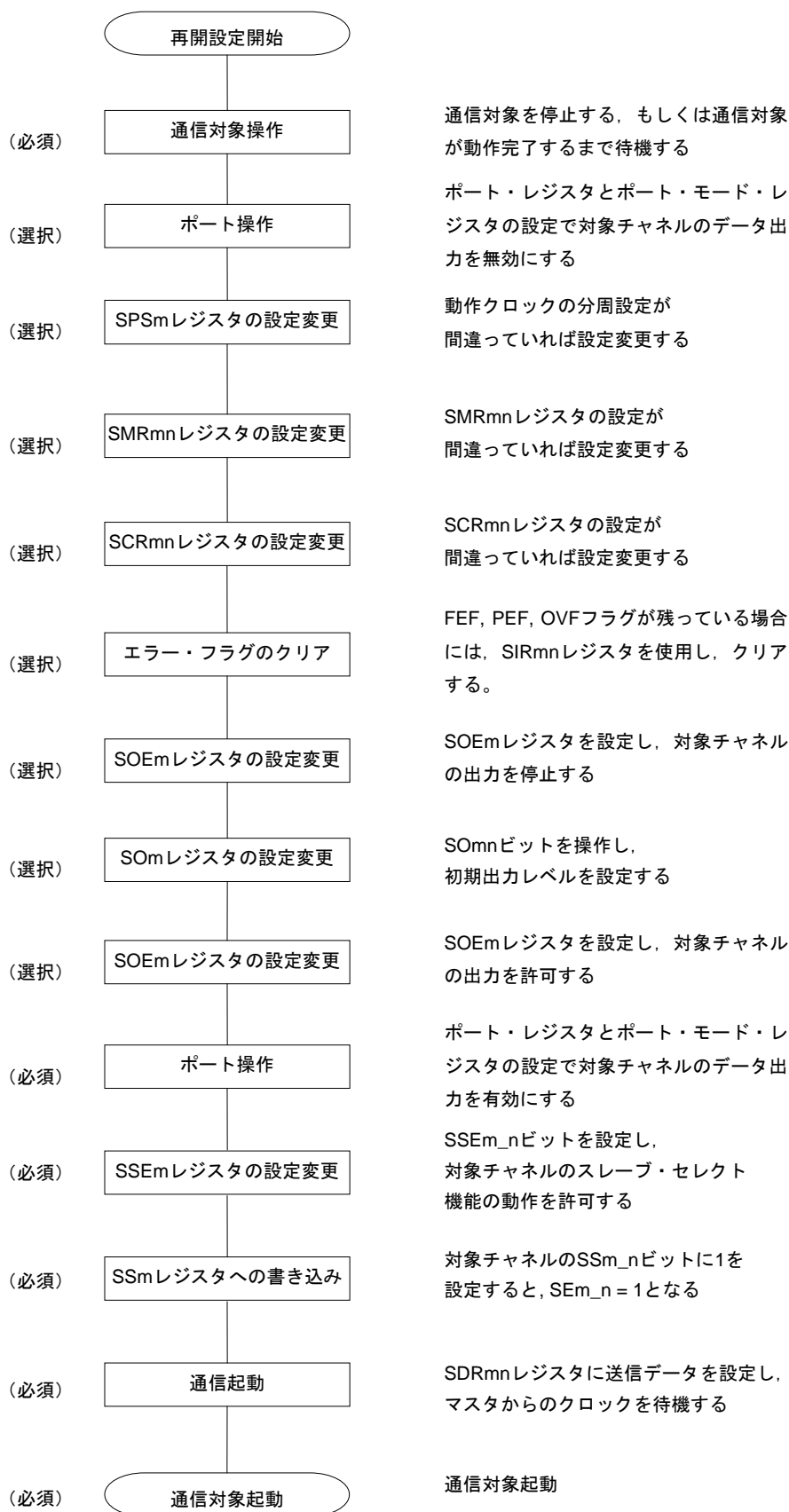
図11-103 スレーブ送信の再開設定手順
