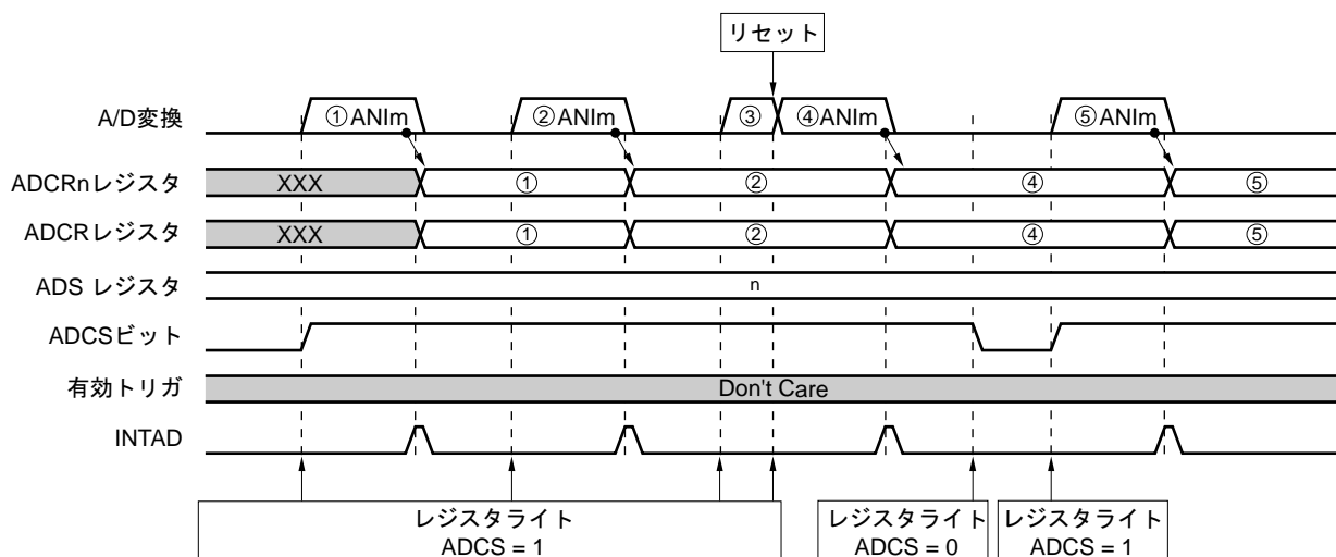
図10-24 ワンショット・セレクト・モード動作タイミング例（ソフトウェア・トリガ・モード）
