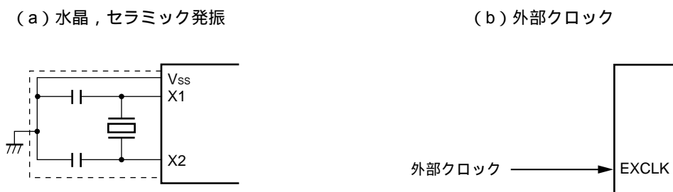
図5 - 9 X1発振回路の外付け回路例
