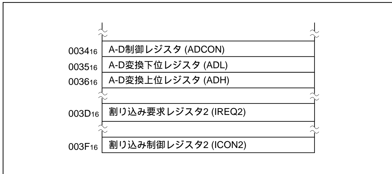
図2.6.1 A-D変換器関連レジスタのメモリ配置
