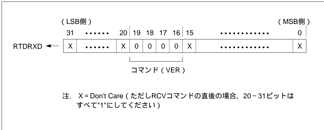
図14.3.6 VER(継続モニタ)コマンドデータフォーマット
