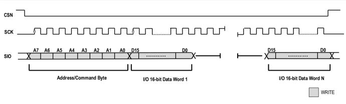
Figure 12. SPI Burst WRITE
