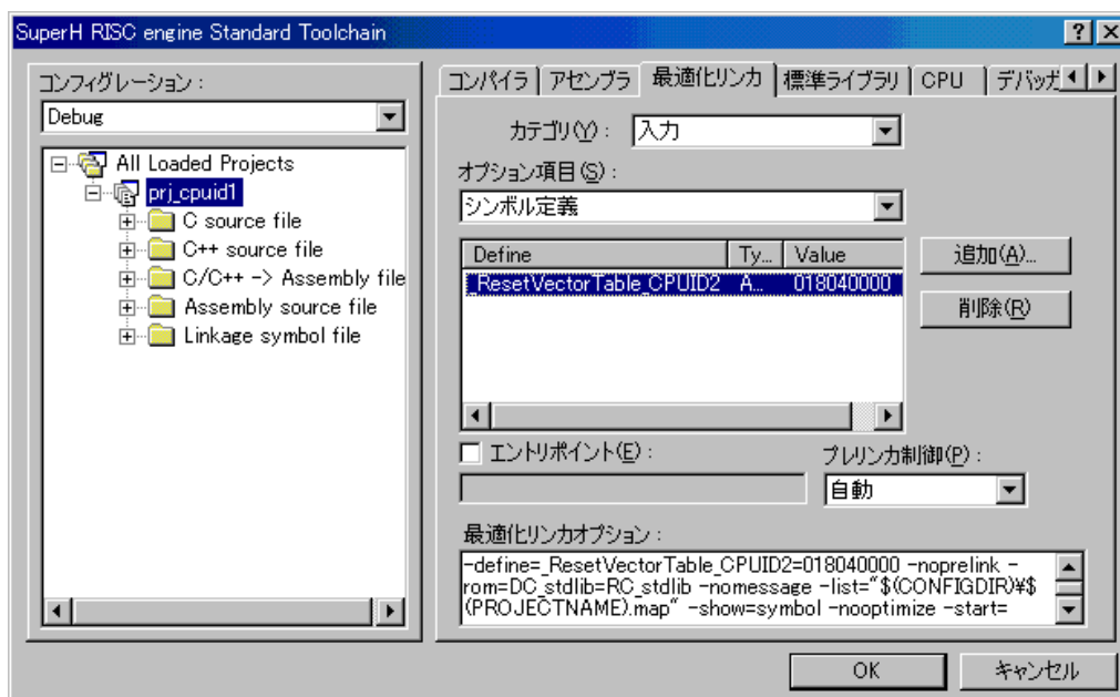
図17.29 最適化リンカ・CPUID#2の仮想リセットベクタテーブルのシンボル定義
