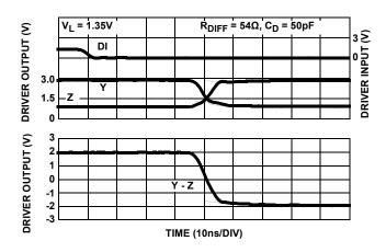
FIGURE 15. DRIVER WAVEFORMS, HIGH TO LOW
