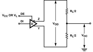
FIGURE 1A. V<sub>OD</sub> AND V<sub>OC</sub>
