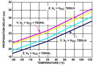
FIGURE 14. SINGLE-ENDED PROPAGATION DELAY vs TEMPERATURE
