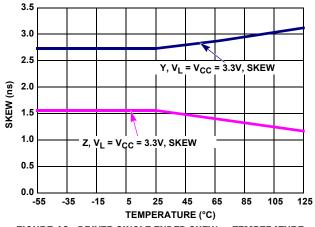
FIGURE 13. DRIVER SINGLE-ENDED SKEW vs TEMPERATURE
