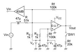
(1)  $A_{VD}$ :  $R_S=1k\Omega,\,Rf=100k\Omega,\,R_L=\infty,\,V_1=V_2=1/2\,\,V_{CC}$
