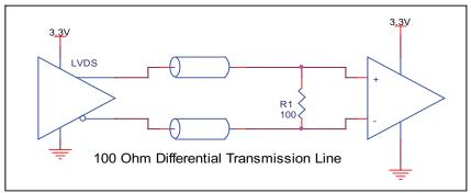
FIGURE 3. TYPICAL LVDS DRIVER TERMINATION
