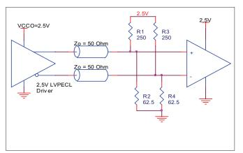
FIGURE 5A. 2.5V LVPECL DRIVER TERMINATION EXAMPLE
