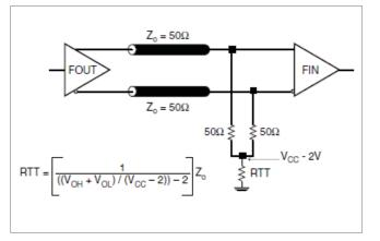
FIGURE 4A. LVPECL OUTPUT TERMINATION
