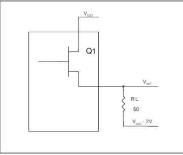
FIGURE 6. LVPECL DRIVER CIRCUIT AND TERMINATION
