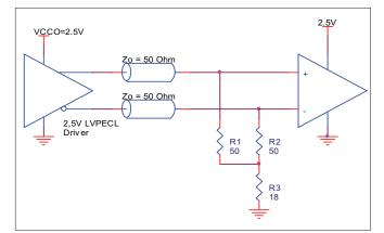
FIGURE 5B. 2.5V LVPECL DRIVER TERMINATION EXAMPLE
