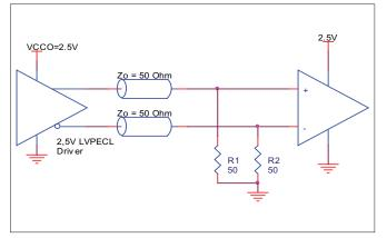
FIGURE 5C. 2.5V LVPECL TERMINATION EXAMPLE
