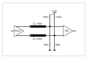
FIGURE 4B. LVPECL OUTPUT TERMINATION
