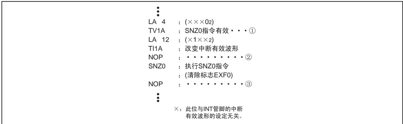
图 DD-8 外部 0 中断程序例子 3
