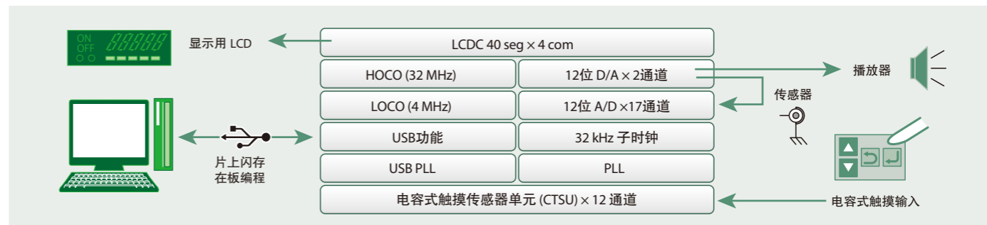
■应用实例：使用RX113的计量设备系统框图
