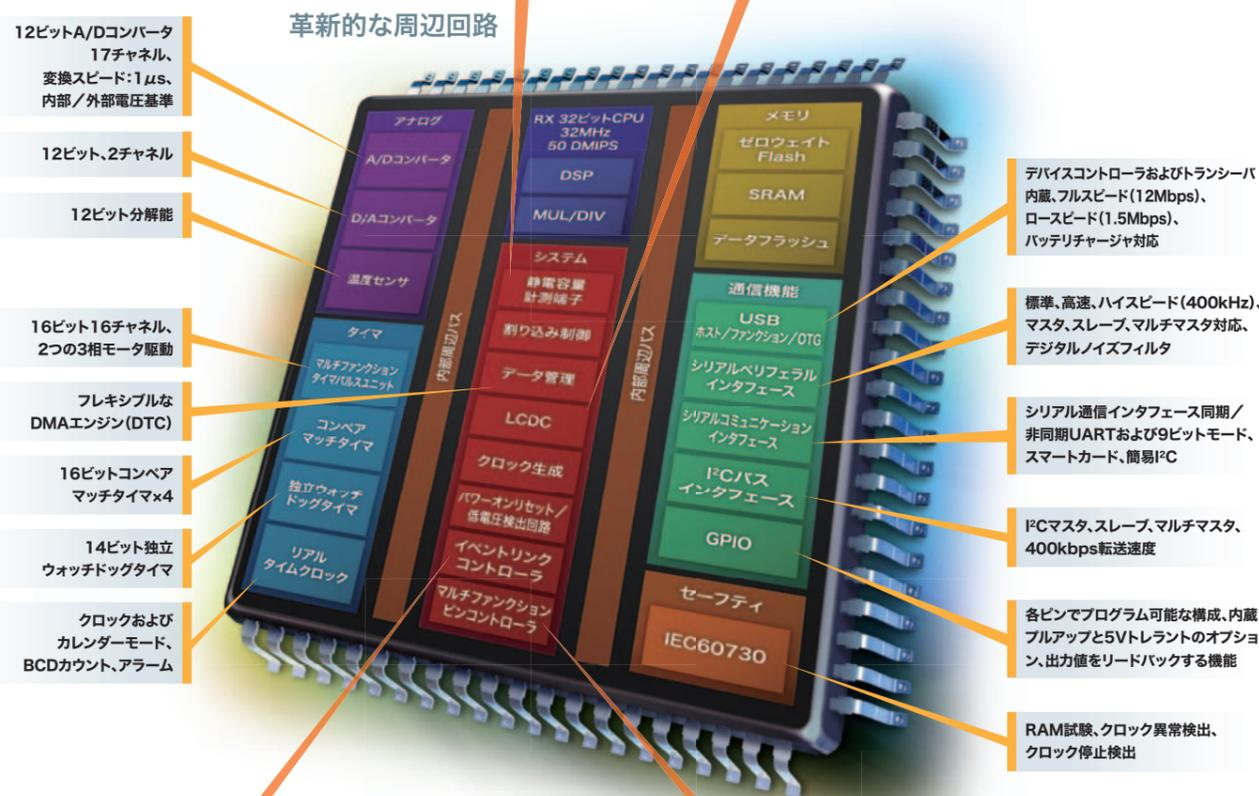
イベントリンクコントローラ (ELC) は、1つの周辺回路またはモジュールから別のモジュールへ割り込みイベント信号を直接入力することにより負荷を軽減する革新的な手段です。これにより、消費電力、割り込み待ち時間、およびプログラムサイズを最小化します。
