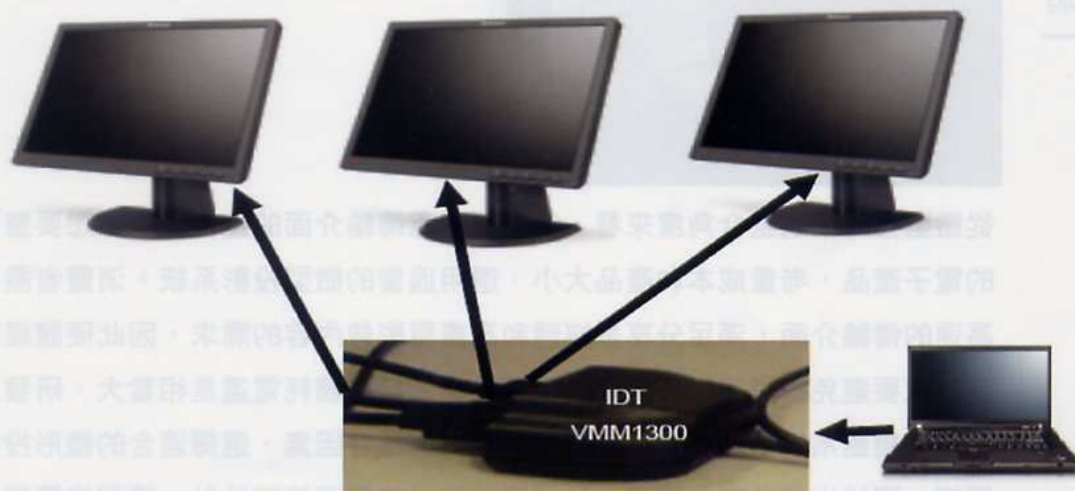
《圖三 DisplayPort的中樞連接模式》
