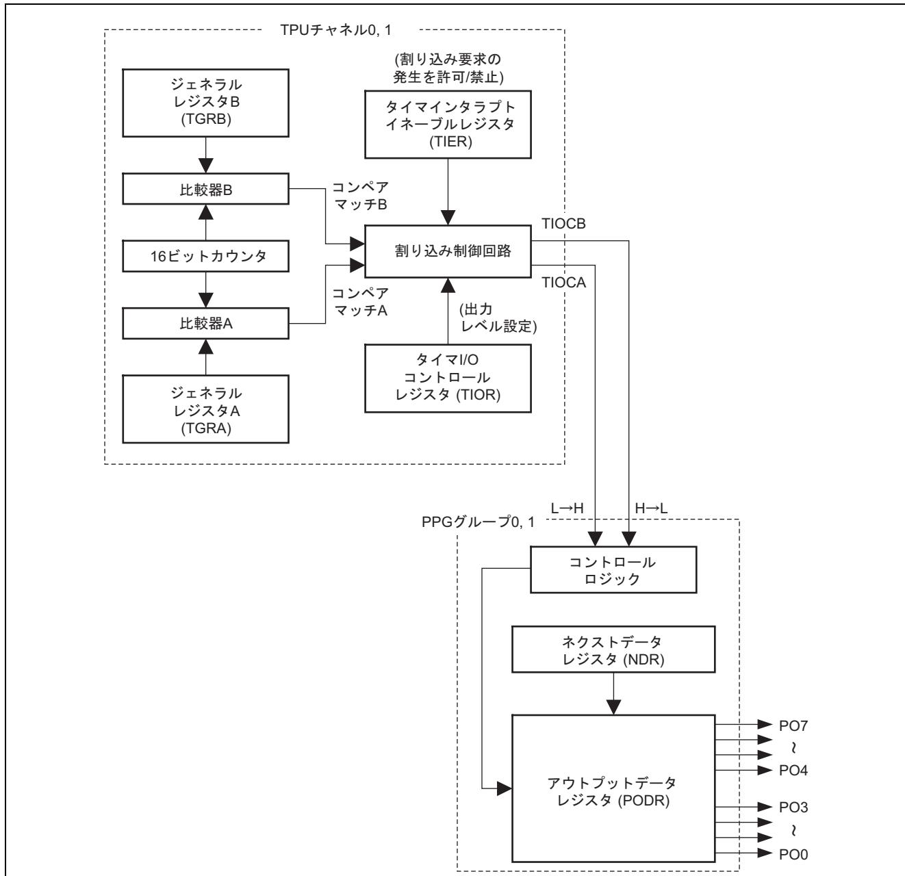
図 2 4 ビット × 2 系統出力 (グループ 0, 1) ブロック図
