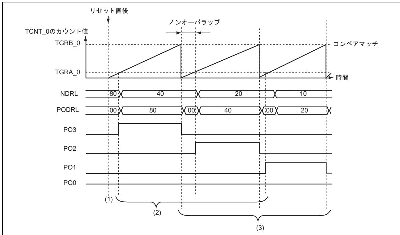
図3 4ビット×2系統出力(グループ0)動作原理
