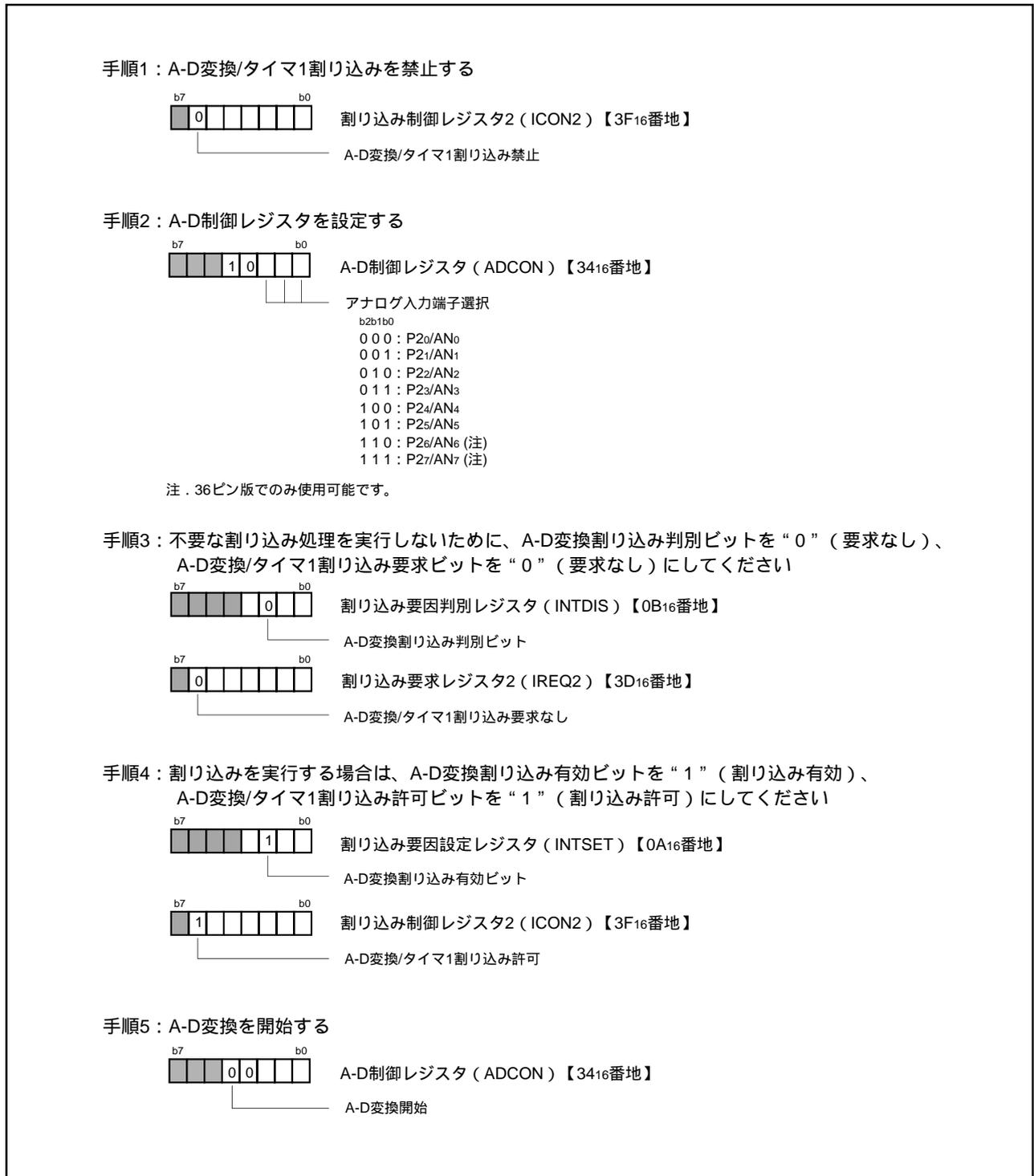
図1 . A-D変換器の設定方法
