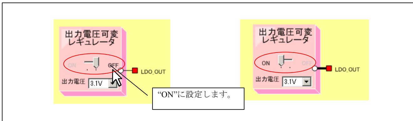
図 3-21 出力電圧可変レギュレータ設定
