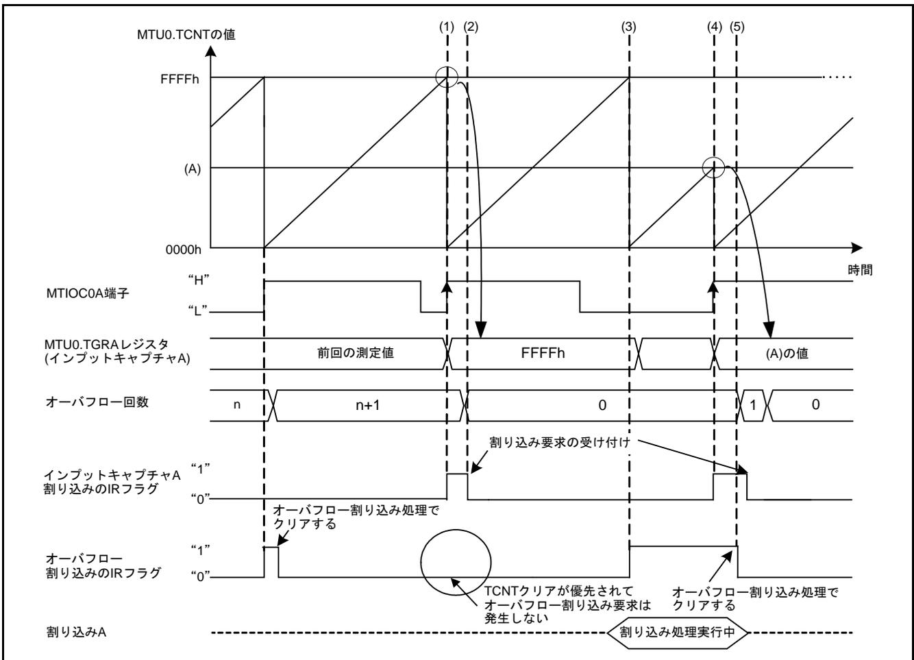
図5.2 インพุットキャプチャとオーバーフローが同時に発生したときのタイミング図
