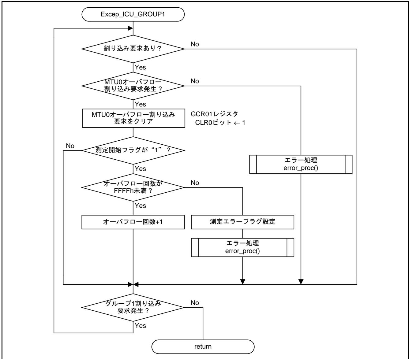
図5.9 MTU0 オーバフロー割り込み処理
