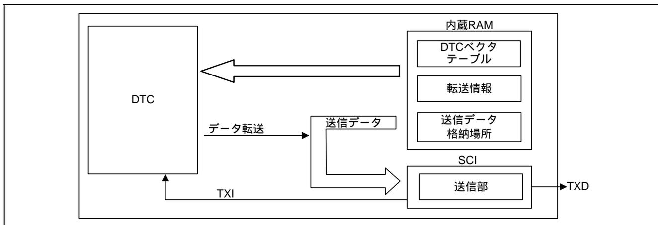
図 1 DTC を用いた調歩同期式シリアルデータ送信の概要
