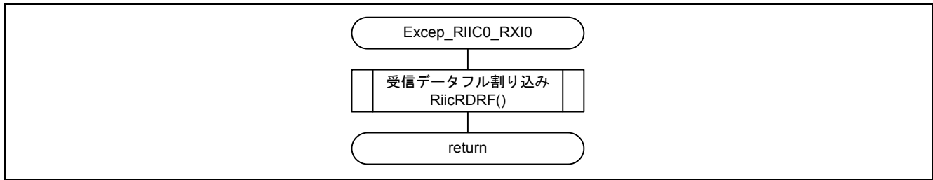
図5.26 RIIC0.RX10 割り込み処理
