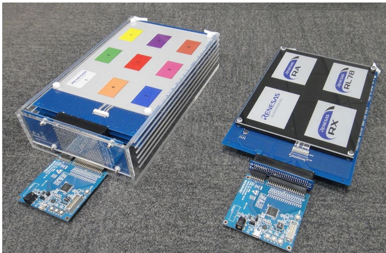
図 1.1 タッチレスボタン電極ボード（左：筐体あり、右：筐体なし）
