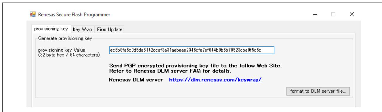
図 7-4 provisioning key タブ 指定値で Provisioning Key を生成する場合の例
