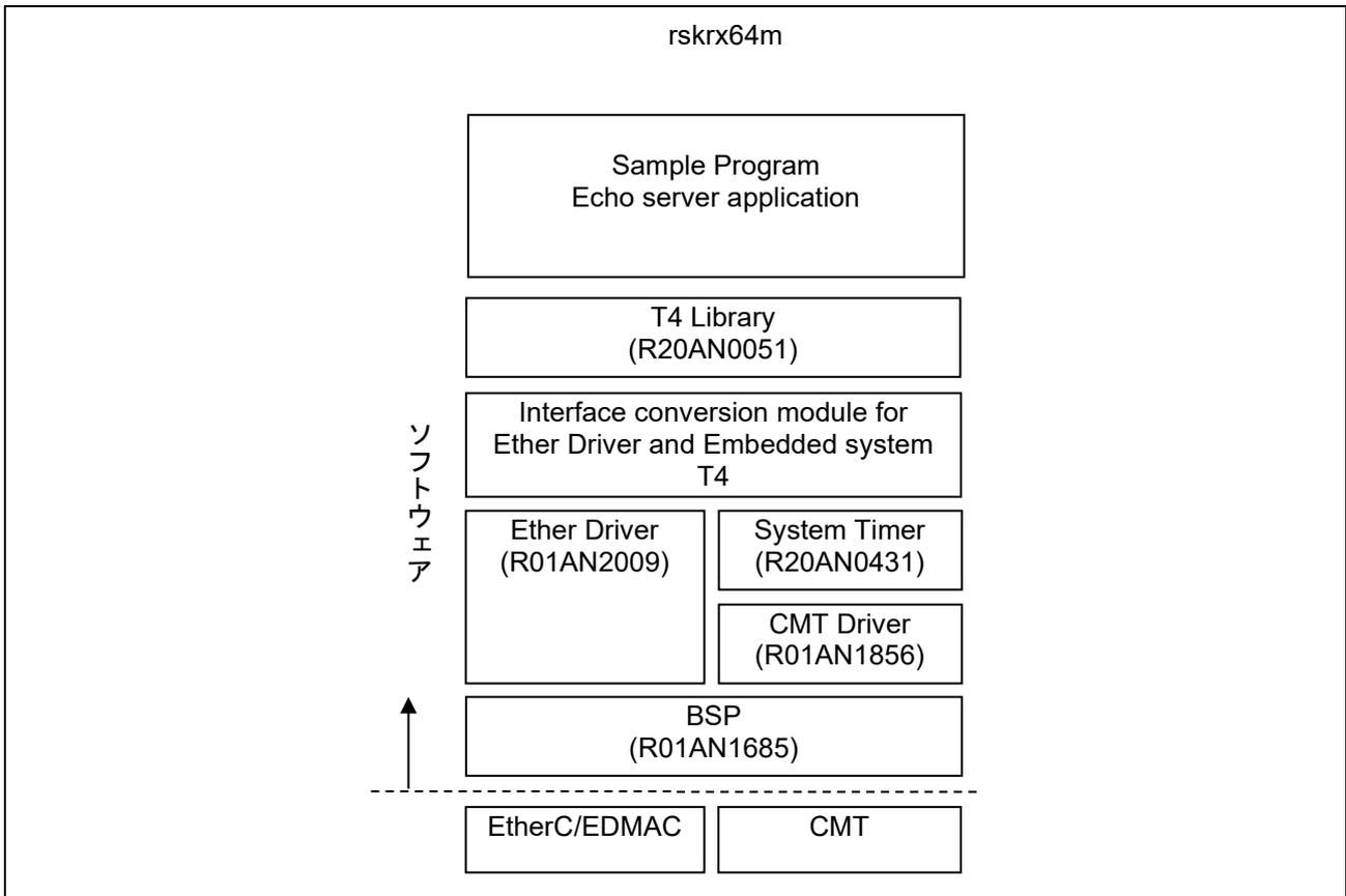
図 5-8 FIT モジュール構成図
