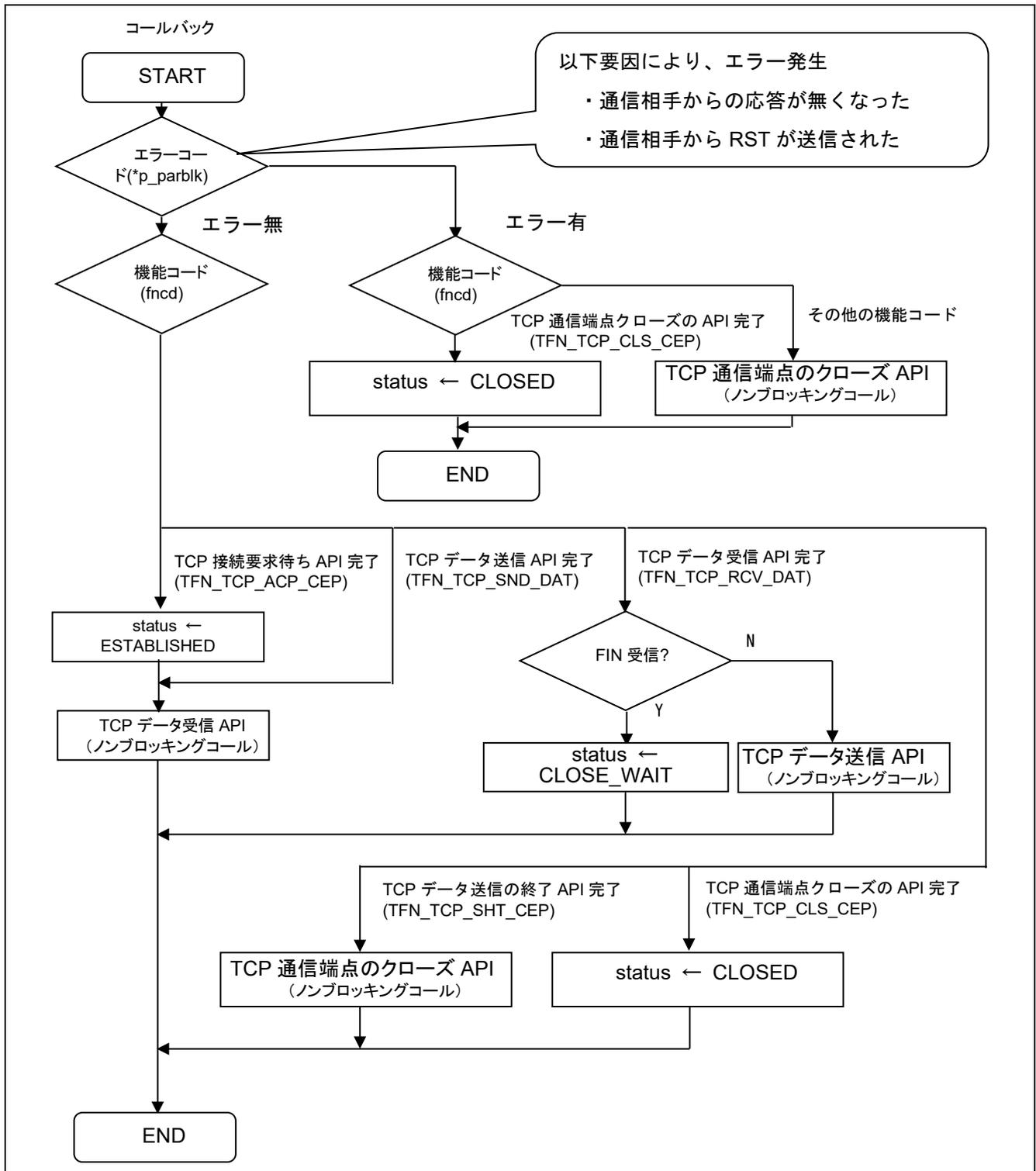
図 5.4 TCP のコールバック (ノンブロッキングコール) の処理フロー
