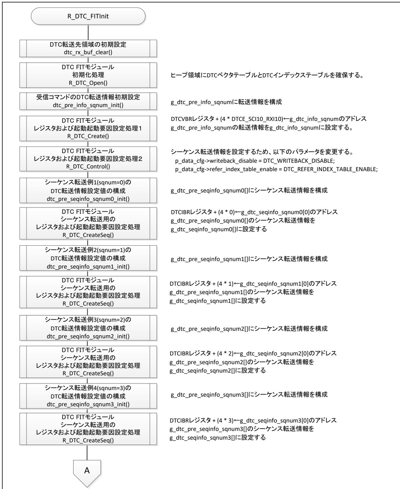
図 4-3 DTC FIT モジュールの初期設定処理 1
