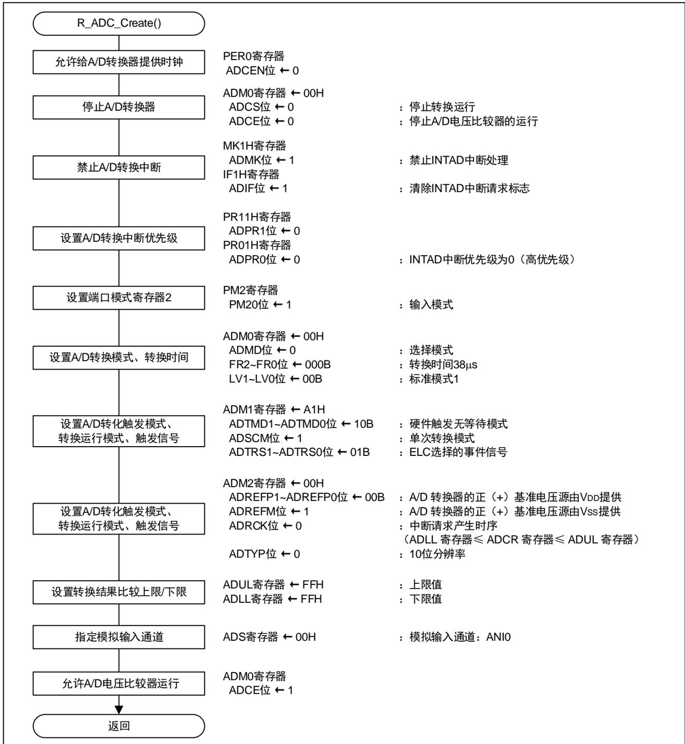
图 5.6 A/D 转换器初始化设置
