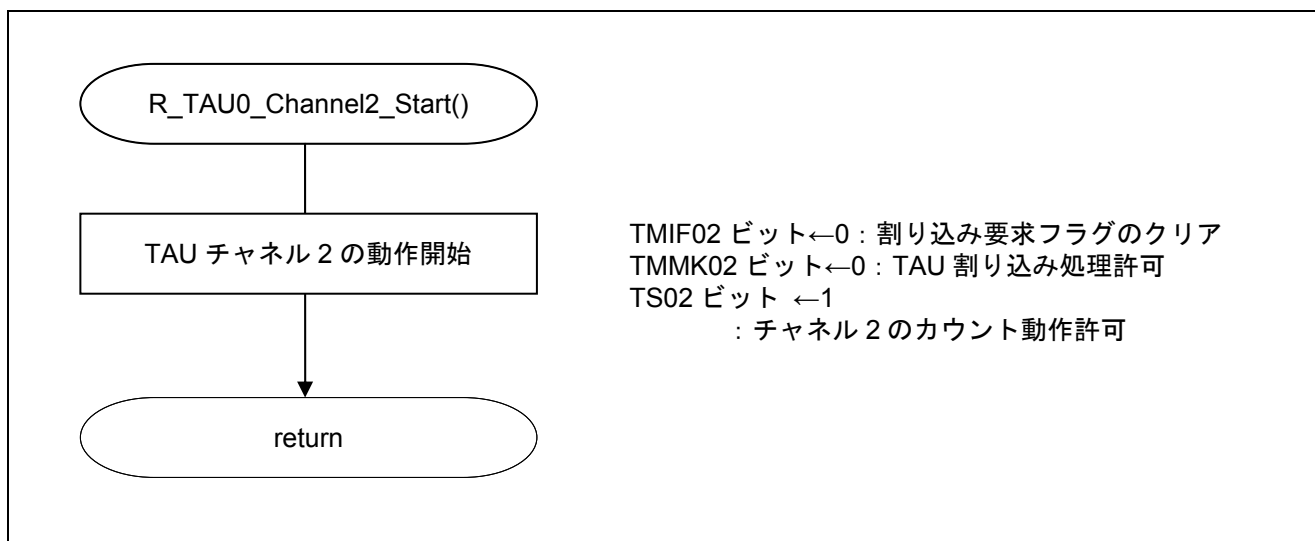
図 5.12 TAU0 (チャンネル2) の動作開始
