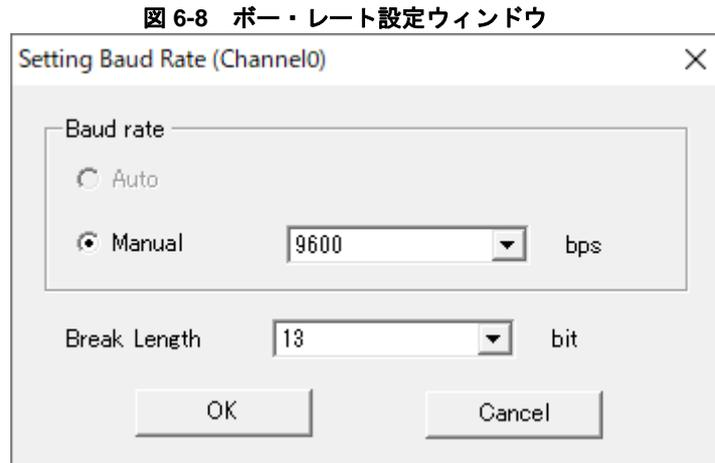
ボー・レートの設定と、送信 Break フィールドのロウ・レベルの長さを設定します。
