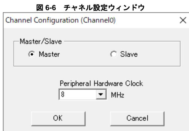
チャネル設定画面では、チャネル毎のマスターとスレーブの切り替え、LIN ドライバが使用するクロック周波数を選択します。設定後、“OK”をクリックしてください。
