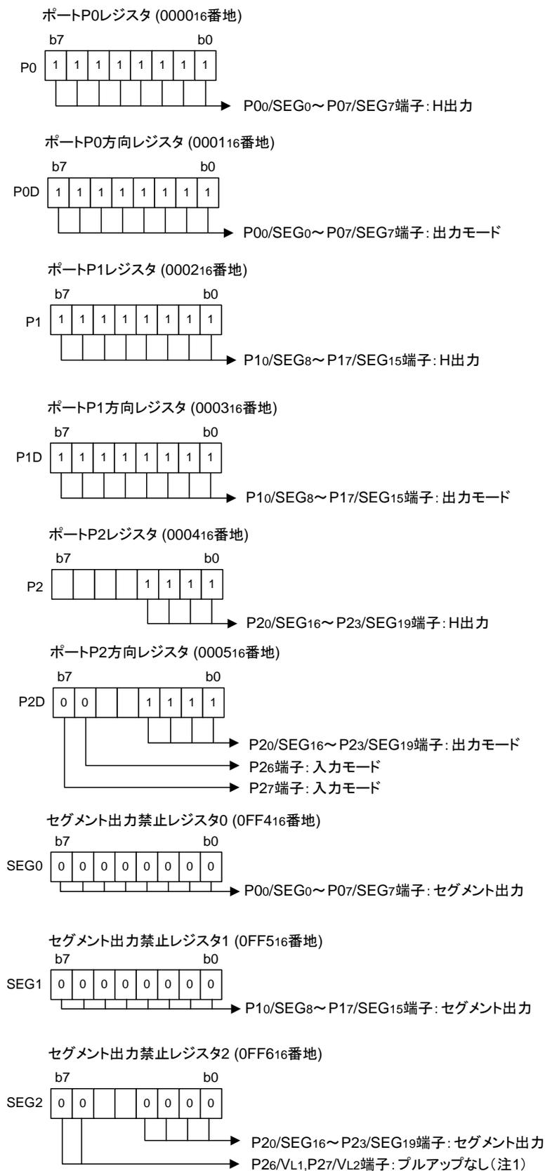
注1.LCD電源制御レジスタ(0014<sub>16</sub>番地)のVL端子入力選択ビット(VLSEL)が"1"の場合、セグメント出力禁止ビット22,23の設定は無効になります。
