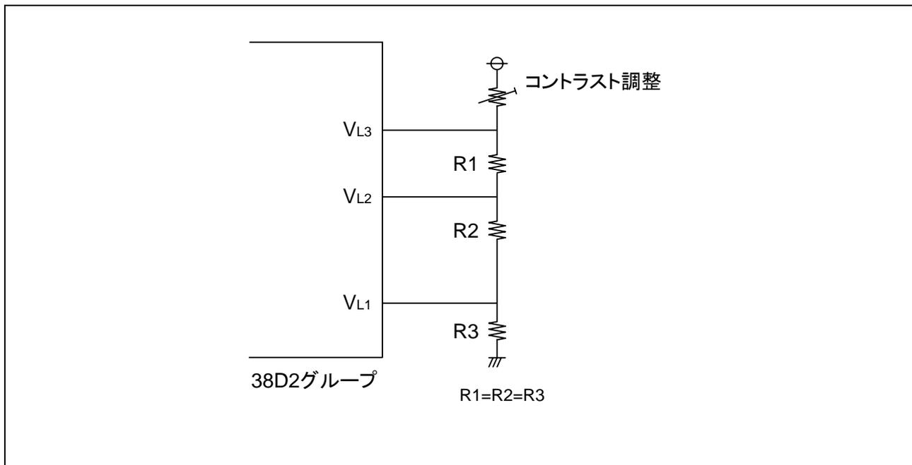
図 3.2 回路例（外部分割抵抗使用時）
