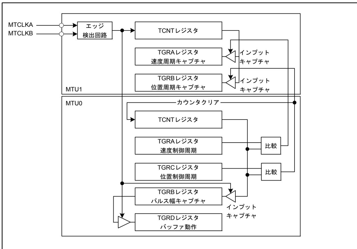
図 5.1 位相計数モードの応用例
