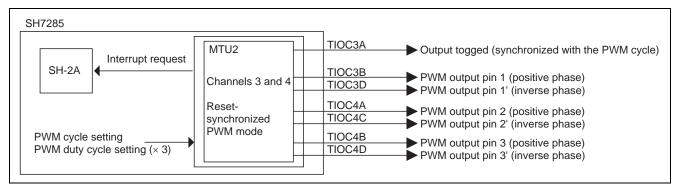
Figure 1 Three-Phase Output of PWM (Reset-Synchronized PWM Mode)
