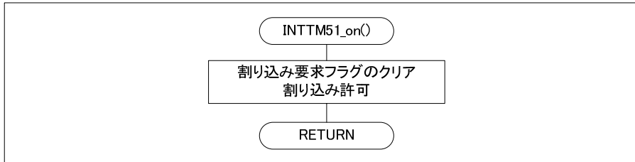
図 4 - 45 電流マイナー割り込み許可処理 (INTTM51_on 関数)
