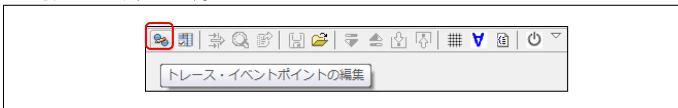
図7 トレース・ツールバーの"トレース・イベントポイントの編集"アイコン
